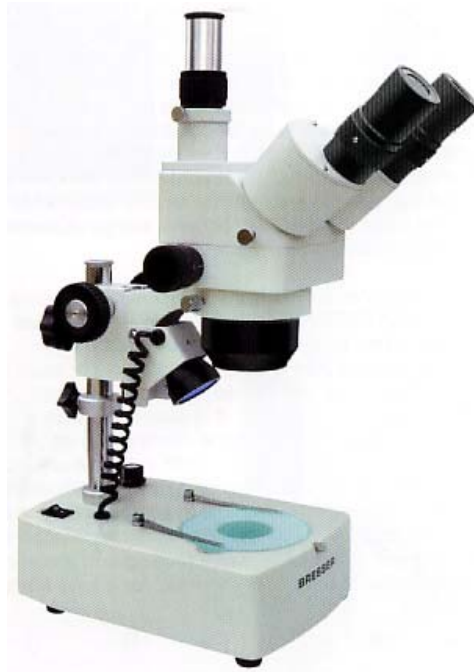
Obrázek 5-6: Mikroskop pro laboratorní hodnocení struktury betonu
