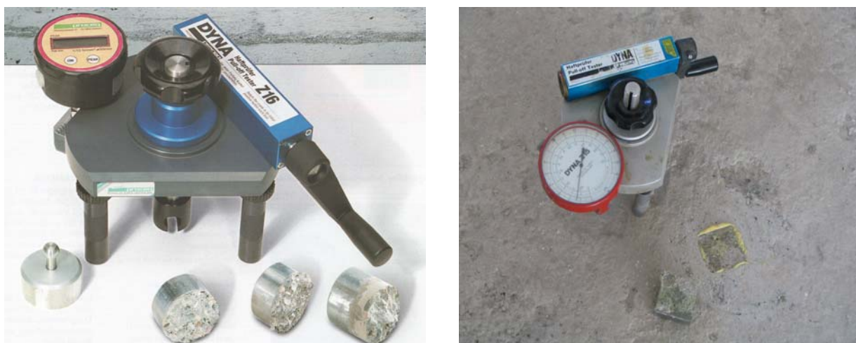
Obrázek 5-3: Fotografie odtrhové aparatury DYNA a odebrané vzorky
