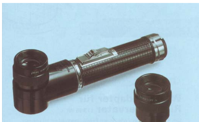
Obrázek 5-7: Pravítko a lupa pro odečet šířky trhlin
