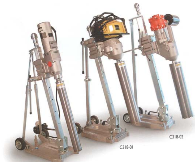
Obrázek 5-1: Vrtačky pro odběr jádrových vzorků
